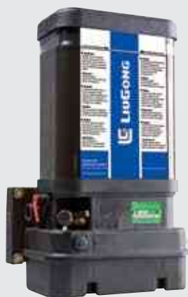
Un sistema de engrase automático mejora la vida útil del rodamiento y reduce las reparaciones proporcionando cantidades exactas y regulares de grasa a cada rodamiento.
